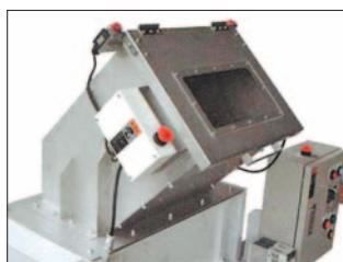
投入口蓋開放時には起動しません
