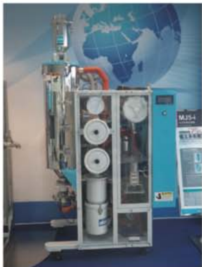
図4 MATSUI (ASIA) 社の射出成形用周辺機器(樹脂乾燥機) 樹脂の消費量に合わせて乾燥風量などを最適に保つ機能を持たせ、しかも省エネルギー性を高めた。
