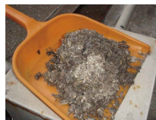
除去されたスケール
